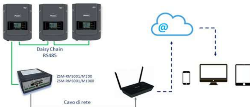
Rysunek 218 - Schemat funkcjonalny rejestratora danych ZSM-RMS001/M200 / ZSM-RMS001/M1000
