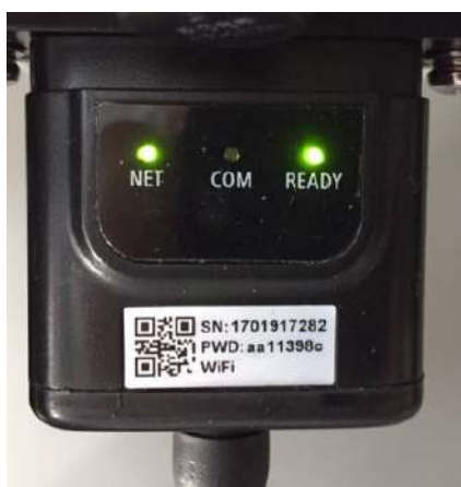
Rysunek 198 - Nieprawidłowy stan komunikacji pomiędzy falownikiem a kartą
