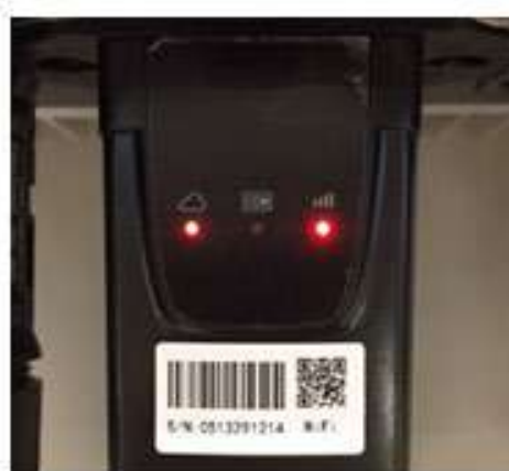
Rysunek 198 - Nieprawidłowy stan komunikacji pomiędzy falownikiem a kartą
