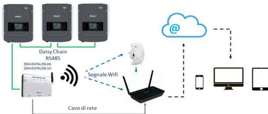
Rysunek 217 – Schemat podłączenia rejestratora danych ZSM-DATALOG-04 / ZSM-DATALOG-10
