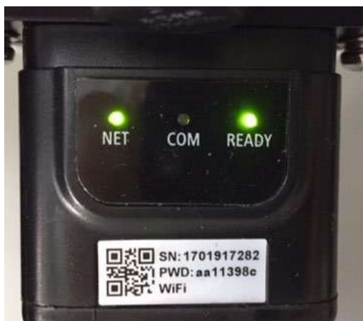
Rysunek 209 - Nieprawidłowy stan komunikacji pomiędzy falownikiem a kartą
