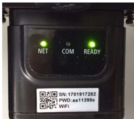
Rysunek 215 - Nieprawidłowy stan komunikacji pomiędzy falownikiem a kartą
