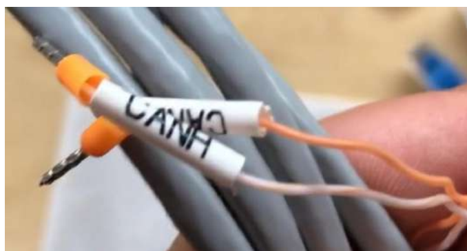
Rysunek 70 - Przewód komunikacyjny Falownik/HV BOX
