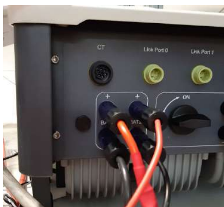
Rysunek 87 - Podłączenie mocy prądu stałego po stronie falownika z dwoma wejściami baterii
