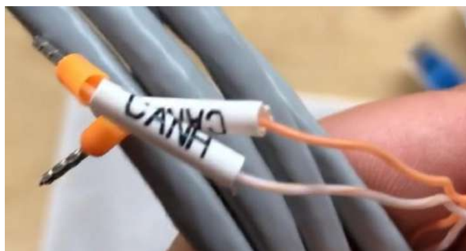
Rysunek 93 - Przewód komunikacyjny Falownik/HV BOX
