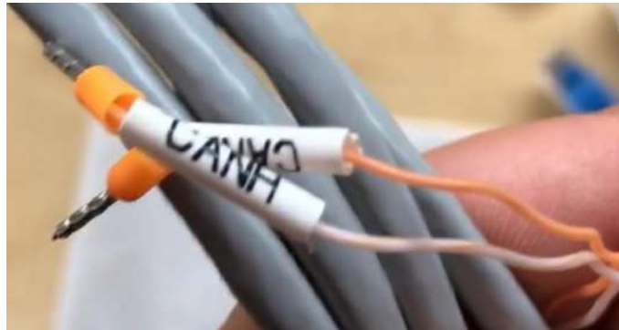
Rysunek 105 - Przewód komunikacyjny Falownik/HV BOX
